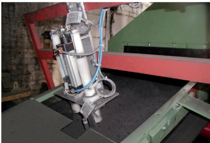
Bild 4: Feuchtemesssonde auf Band (datec)
